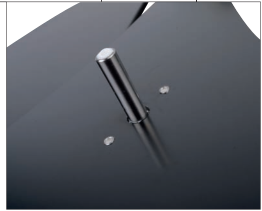
Die Tellerachse trägt oben ein Teflonplättchen, gegen das die Lagerkugel läuft
