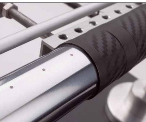
Durch diese Löcher strömt die Lagerluft
