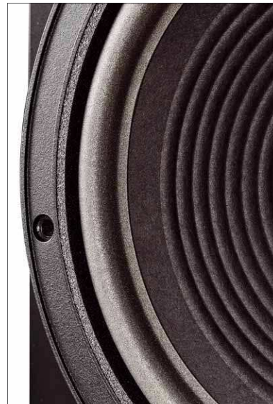
Besonders verlustarm: die Schaumstoffsicke des Tieftöners
