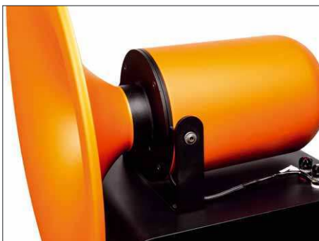
Der große 2"-Druckkammertreiber steckt in einem Rohr hinter dem Trichter
