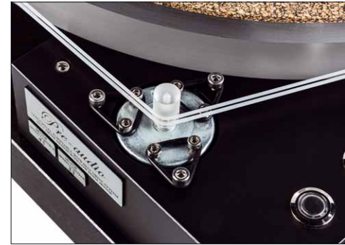
Das Drehmoment des Motors gelangt über zwei weiche Silikonriemen zum Teller
