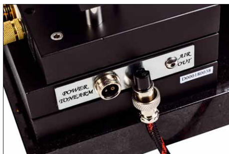
Durch diesen Verbinder geht nicht nur Strom, sondern auch Luft vom Kompressor im Netzteil
