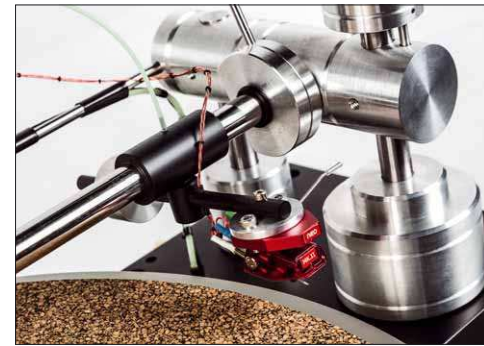
Hier passiert's: Durch den Schlauch wird Druckluft in die Hülse geblasen, der Arm schwebt auf dem resultierenden Luftpolster
