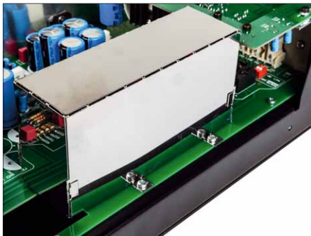
Die empfindlichen Tonabnehmersignale werden unter einer Abschirmung „behandelt“
