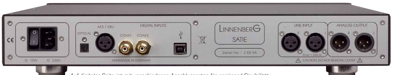
Auf digitaler Seite ist mit verschiedenen Anschlussarten für genügend Flexibilität gesorgt, doch einzig der USB-Anschluss erlaubt Abtastraten über 192 kHz
