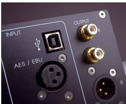
XLR ist die erste Wahl bei den Ausgängen, sodass man den Cinch-Anschluss getrost zum Eingang umrüsten kann
