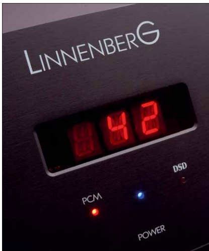
Das Display schaltet sich nach dem Ändern einer Einstellung automatisch nach wenigen Sekunden ab
