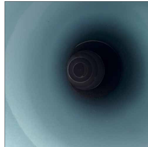
Am Hornhals kann man den Druckkammer-treiber erkennen, der ab etwa 1 Kilohertz das Musiksignal wandelt
