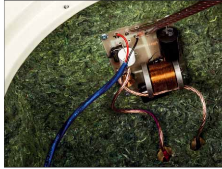
Die Frequenzweiche trennt die beiden Chassis mit 12 dB bei 1200 Hz und kommt mit wenigen hochwertigen Bauteilen aus
