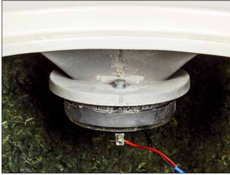
Der 1" Horntreiber mit Alu-Membran ist un-mittelbar an das gegossene Horn angeflanscht
