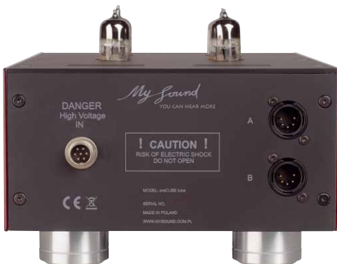
Für sich allein genommen bietet das Röhrenteil keine Funktion, der Anschluss an den PreCube ist unumgänglich
